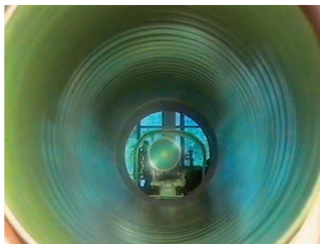
Revêtement intérieur automatique en polyuréthane (PUR).
