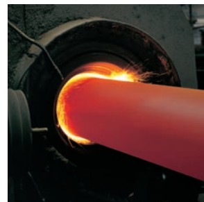
La fabrication des tuyaux est effectuée par centrifugation sur les installations modernes de vonRoll à Choindez, en Suisse.
