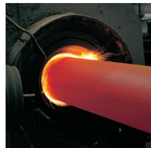
Die Herstellung der Rohre erfolgt im Schleudergussverfahren auf modernen Anlagen im eigenen Werk in Choindex / Schweiz.
