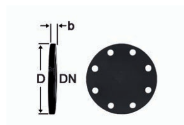
Flansch nach DIN EN 1092 Teil 2, gebohrt
