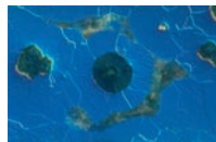
Fonte ductile à graphite sphéroïdal. (image prise au microscope électronique.)
