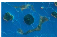
Duktiles Gusseisen mit kugelförmig ausgebildetem Graphit. (Rasterelektronenmikroskop-Aufnahme.)
