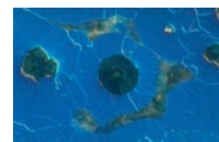
Hierro fundido dúctil con formación de grafito esferoidal (captura con microscopio electrónico de barrido)
