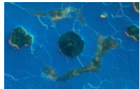
Duktils Gusseisen mit kugelförmig ausgebildetem Graphit. (Rasterelektronenmikroskop-Aufnahme.)
