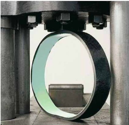
Le revêtement PUR présente une très grande adhérence sur la surface de la fonte.
