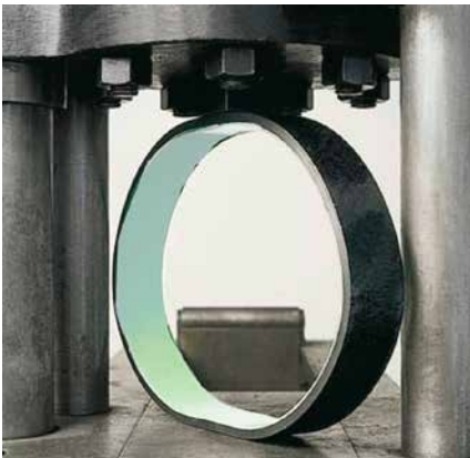
Die PUR-Beschichtung hat eine sehr hohe Haftfestigkeit auf der Gussoberfläche.
